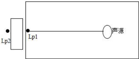
图 4-2 室内声源等效为室外声源图例
